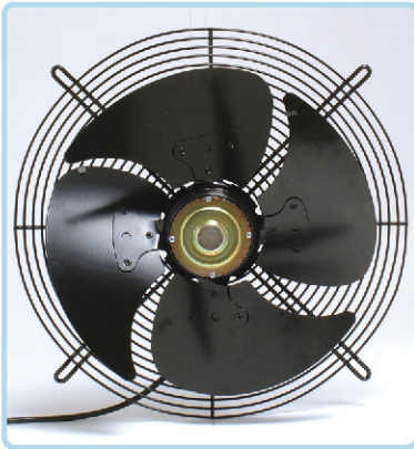
מאוררים מסדרת EXT לקרור ומיזוג אוויר מתוצרת GR איטליה, קוטר 250-450 מ"מ IP55, 700-1400 סל"ד, חד או תלת פאזי
