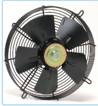
מאוררים מסדרת EXT לקרור ומיזוג אוויר מתוצרת GR איטליה, קוטר 250-450 מ"מ IP55, 700-1400 סל"ד, חד או תלת פאזי
